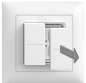
2. Lösen Sie mit Hilfe eines Schraubendrehers Gr. 1 das Funkmodul vorsichtig aus dem Gehäuse heraus.
