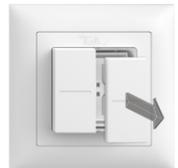
2. À l'aide d'un tournevis taille 1, extrayez délicatement le module radio du boîtier.
