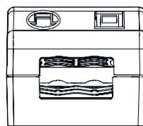
Sekundäre Zugentlastung für Kabel mit kleinerem Kabelmantel
