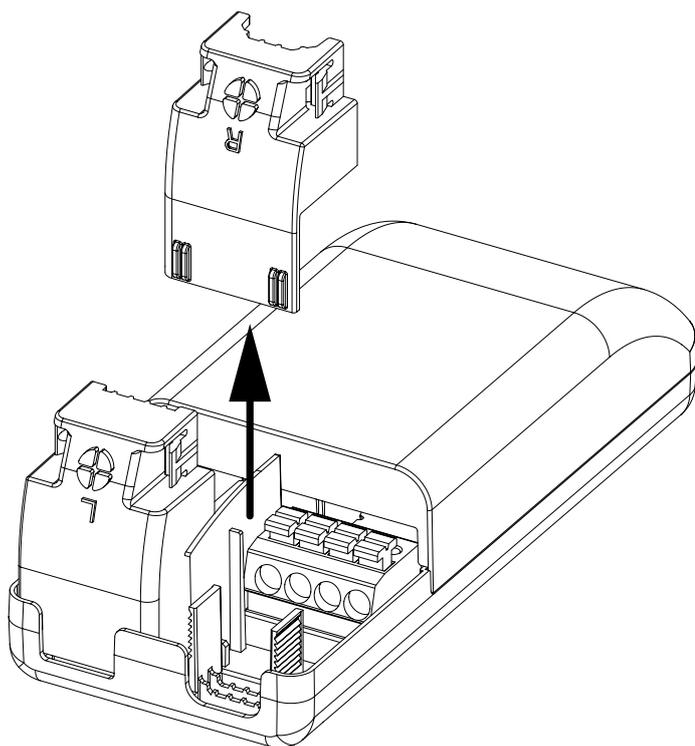
1. Zugentlastungselemente aus Anlieferposition lösen
