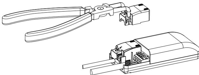
1. Lösevorrichtung in Aussparung einführen, z. B. KNIPEX 46 21 A21 Seeger-Ring Zange oder Schraubenzieher
