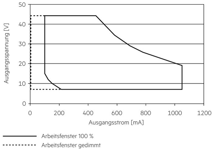
Es ist sicherzustellen, dass der LED-Treiber ausschließlich innerhalb des gezeigten Arbeitsfensters betrieben wird. Besondere Aufmerksamkeit ist dem gedimmten Betrieb sowie dem DC- und Notlichtbetrieb zu widmen, da aufgrund der verwendeten Amplituden-Dimmung die Modulspannung mit dem Dimm-Level variiert. Eine Unterschreitung der spezifizierten minimalen Ausgangsspannung des LED-Treibers kann zur Abschaltung führen. Siehe Abschnitt „6.3 Lichtlevel im DC-Betrieb“ für mehr Informationen.
